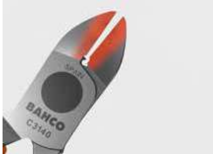
BORDE DE CORTE ENDURECIDO POR INDUCCIÓN Endurecido a 63-65 HRc
